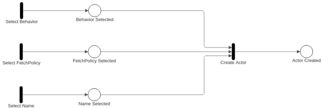
Figura 5.3: Rete di Petri che descrive la creazione di un attore
